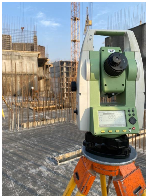
Рисунок 11- Электронный тахеометр Leica TS02plus
