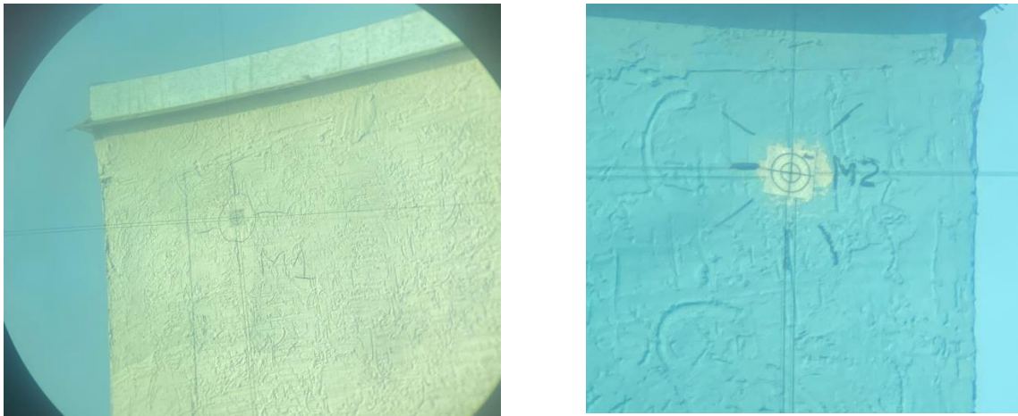
Рисунок 10-Временные геодезические марки
